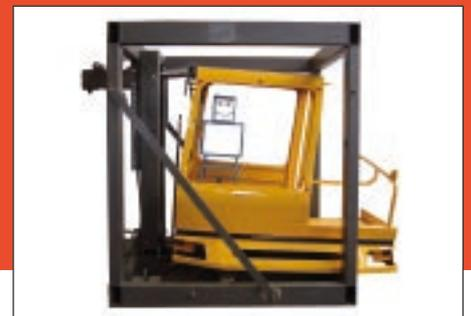
La estructura de la cabina es completamente de acero, espaciosa y segura (cumplen certificación FOPS y ROPS) asegurando máxima protección al conductor
