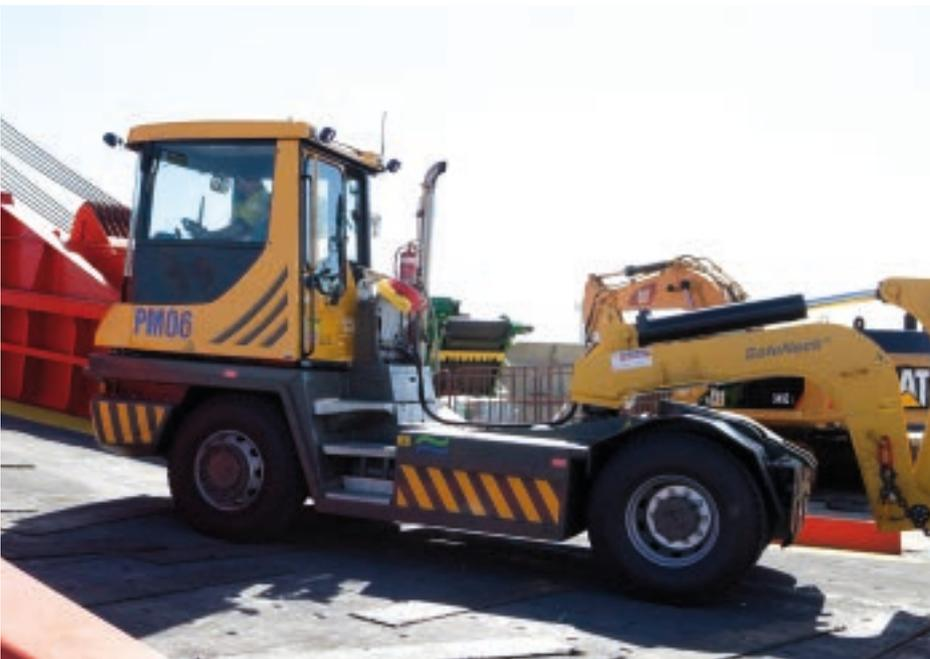
La opción exclusiva Terberg SafeNeck® aumenta la seguridad y capacidad en el manejo de remolques pesados en rampas. El patentado SafeNeck asegura una óptima distribución del peso entre los ejes delanteros y traseros lo cual incrementa la carga admisible hasta un 250%.
