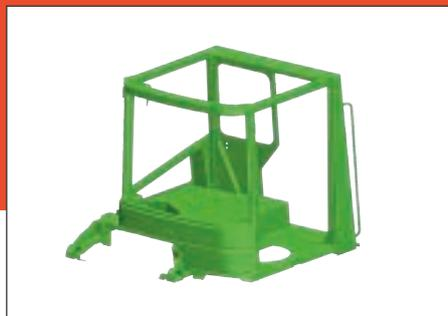
La estructura de la cabina es completamente de acero (cumplen certificación FOPS y ROPS)
